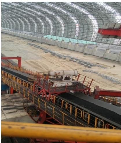
图 4.1-2 1号煤棚堆取料洒水抑尘设施
