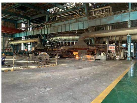
图 4.1-47 2#高炉出铁口
