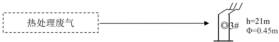
图 3-7 热处理废气处理工艺流程及监测点位示意图
